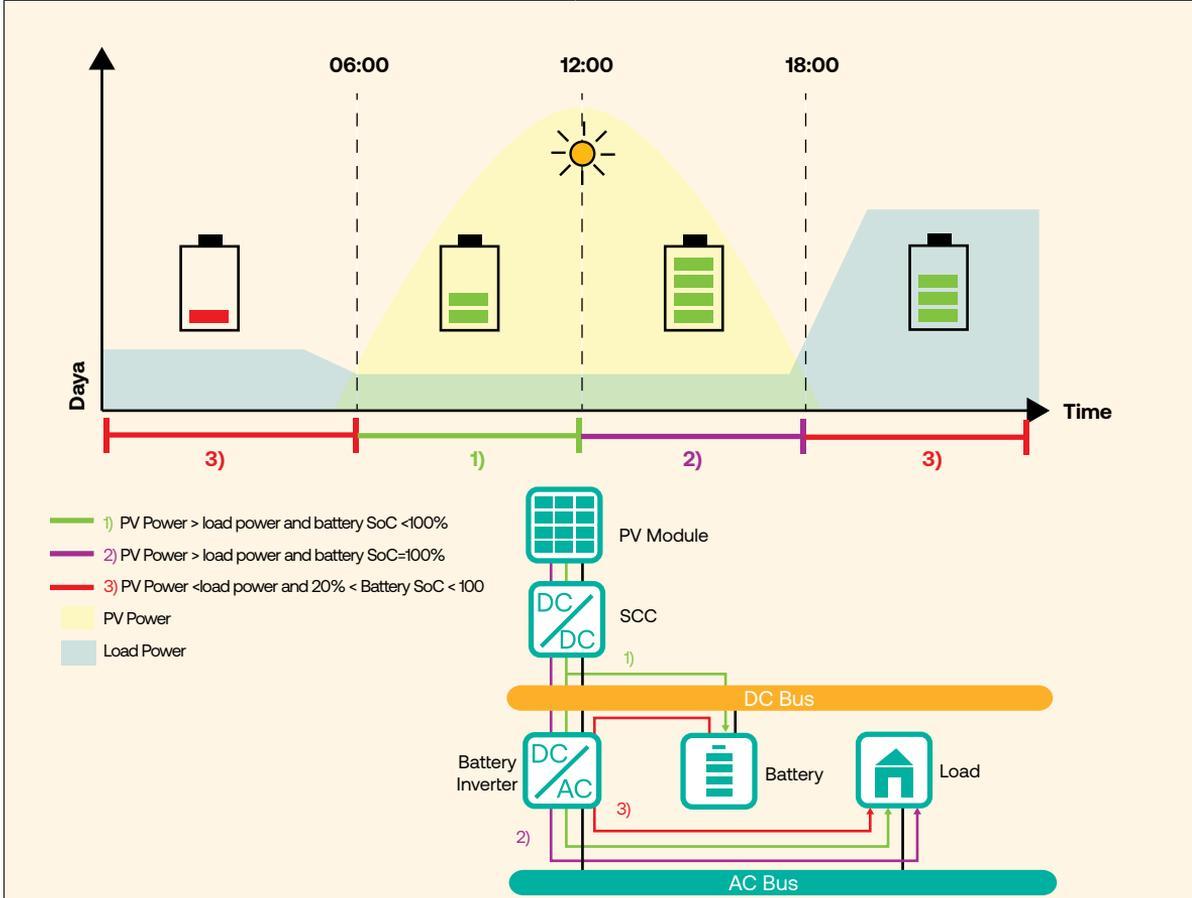
**GRAPHIC 3** DC-Coupling PV mini-grid
