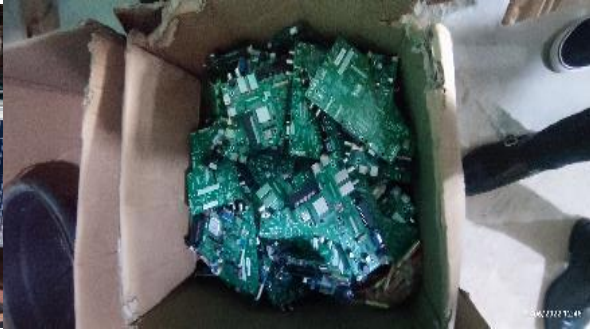
Circuits imprimés démontés d'équipements solaires défectueux
