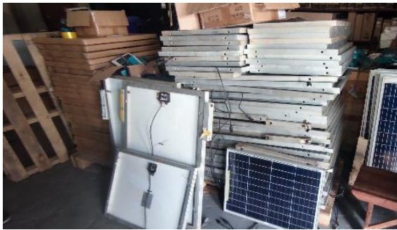
Panneaux solaires défectueux
