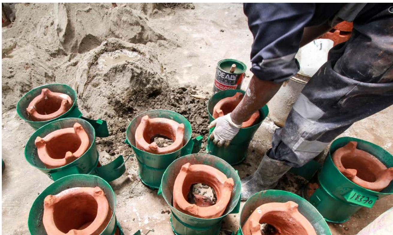
Assemblage de le FA et peinture du revêtement métallique au centre de production de Steloxly à Tharaka Nithi County, Kenya.
