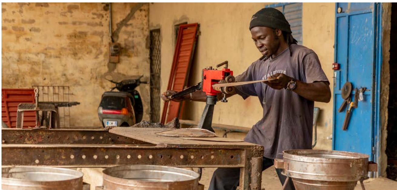
Modou Gamou est en train de plier le métal pour le revêtement métallique du corps principal du FA à Sokone Kaolack, au Sénégal.
