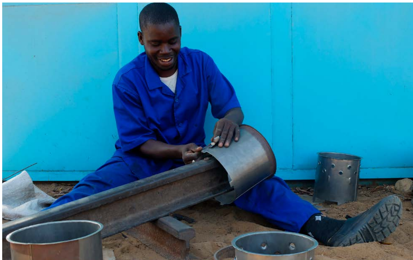
Ousmane Thiam, un fabricant de le FA au Sénégal, façonne les tôles coupées pour en faire un FA à Dakar, au Sénégal.
