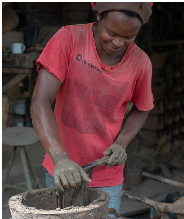
Duncan Kamau moule l'insert ceramic avec le mélange d'argile à l'aide d'un moule préfabriqué au centre de production SOS, Muranga, Kenya.
