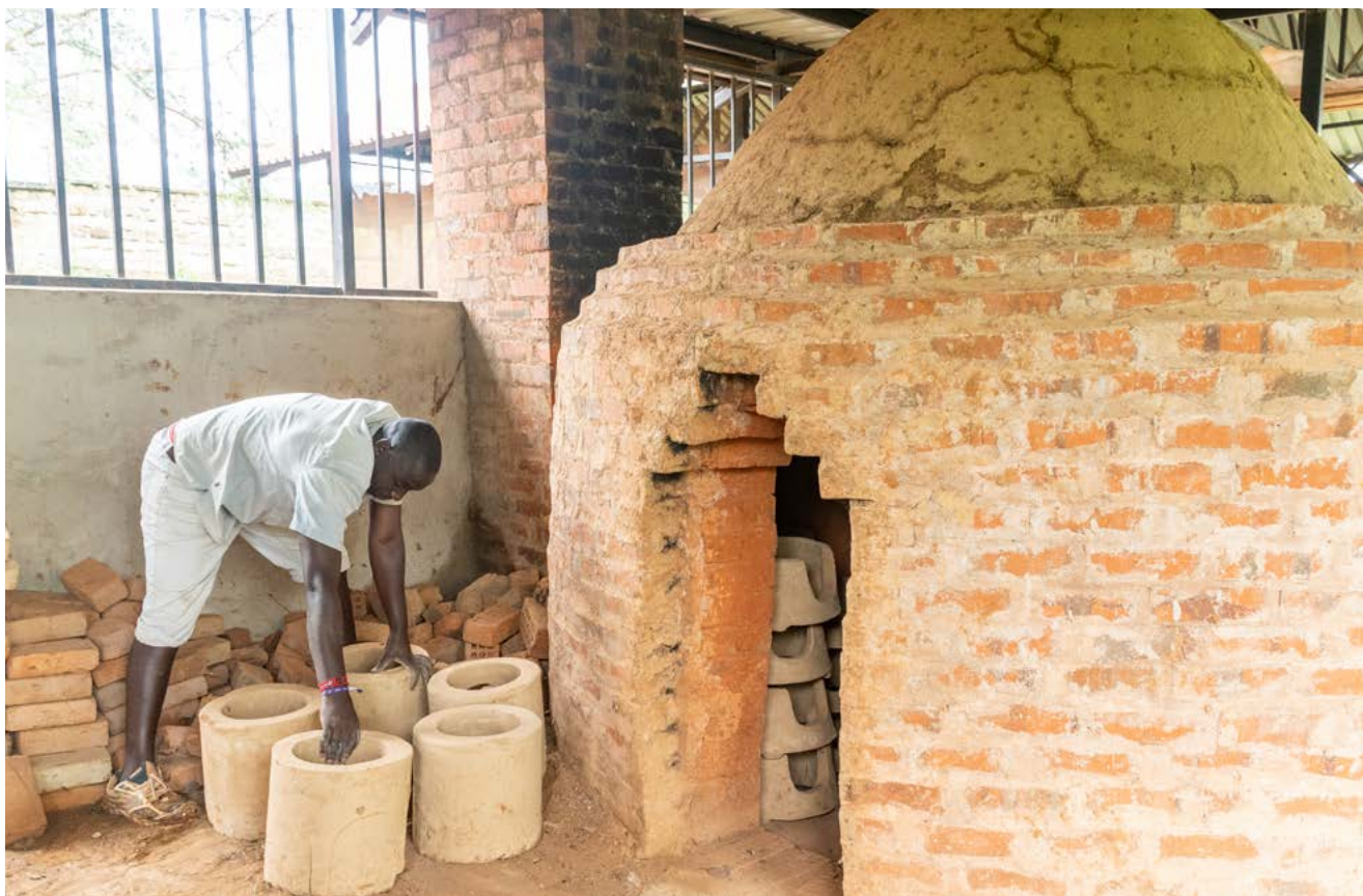
Daniel Kitheka empile les parties ceramiques de le FA dans le four pour les brûler au centre de production Mully Childrens Family, à Yatta, au Kenya.
